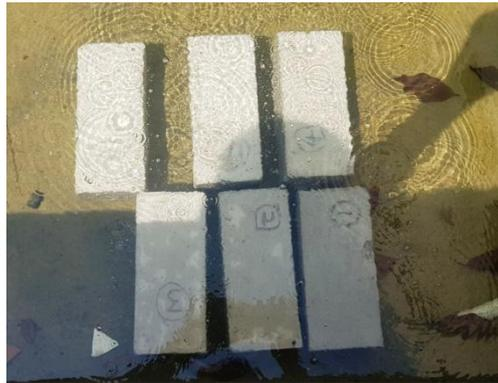
**3. Efflorescence test-** No efflorescence
