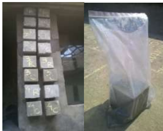
Fig.2. mortar cubes and solar(membrane) curing of cubes
